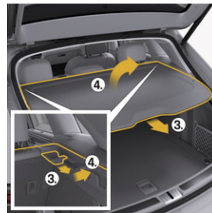
рис. 207: Виймання полиці багажного відсіку
