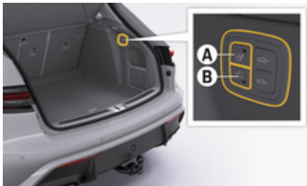
рис. 187: Висування та прибирання тягово-зчіпного пристрою
