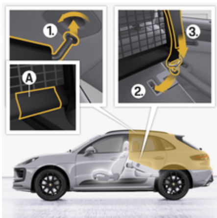
рис. 220: Установка розділювальної сітки зі складеними спинками задніх сидінь
