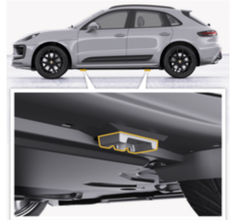
рис. 247: Точка опори для підйомника й домкрата
