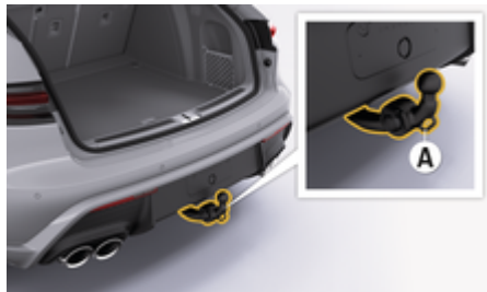
рис. 188: Кріплення страхувального троса причепа за спеціальне вушко
