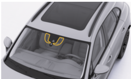
рис. 173: Кріплення пристроїв оплати дорожнього мита
