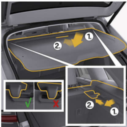
рис. 208: Уставлення полиці багажного відсіку
