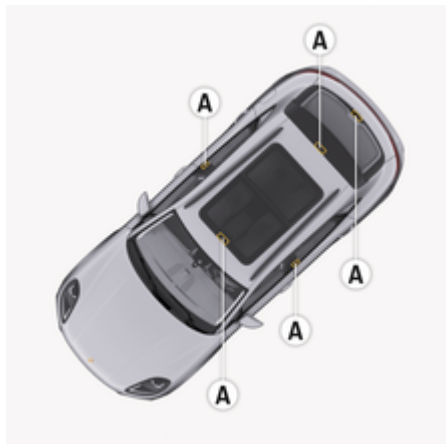
рис. 36: Положення установки радіоантен
